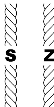
Ryc. 2. Kierunek skrętu nitki: S (lewy) i Z (prawy) (rys. E. Wtorkiewicz-Marosik)
