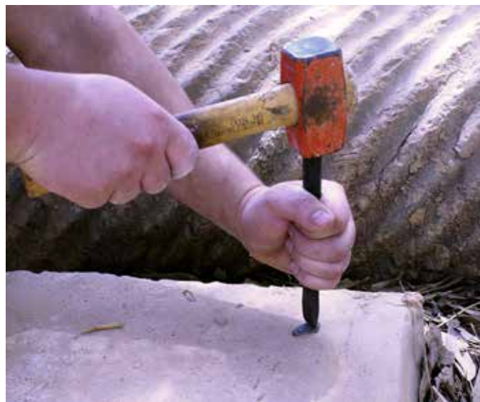
Fig. 4. Jedna z metod cięcia blachy brązowej – doświadczenie z użyciem dłuta płaskiego przeprowadzone w Ptolemais (fot. P. Jaworski).
