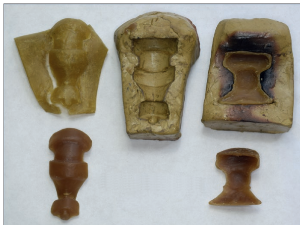
Ryc. 27. Etapy produkcji modeli woskowych zapinek typów A. V 94 i A. V 128. Bez skali. Fot.: J. Strobin
