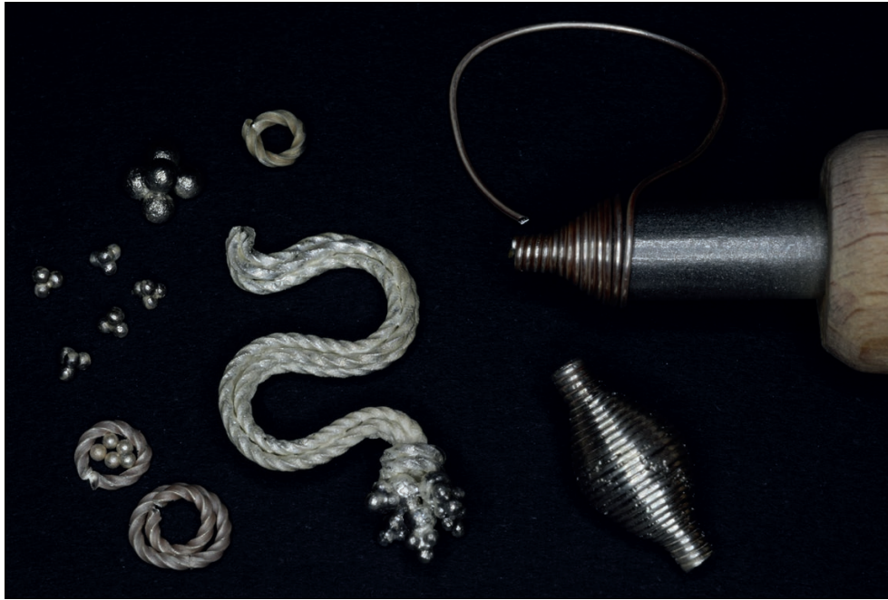
Ryc. 29. Etapy wykonania klamerki esowatej typu von Müller B i paciorka dwustożkowatego (srebro próby 980; filigran i granulacja). Bez skali. Fot.: J. Strobin
