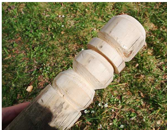
Półprodukt wykonany na rekonstrukcji średniowiecznej tokarki (fot. K. Bonio)
