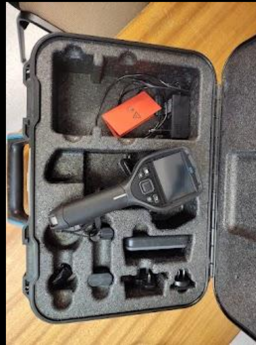
Kamera termowizyjna Flir E60
